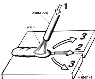
2. Прямолинейное – вдоль оси шва. Обеспечивает необходимую скорость сварки и качественное формирование шва.
