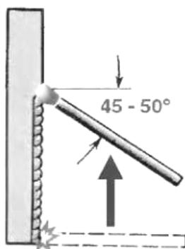
Наиболее удобный, распространенный и производительный способ. Используются электроды до 4мм.
