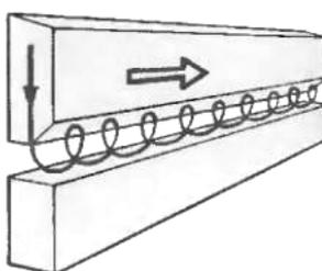
При сварке горизонтальных стыковых швов необходим скос только верхней кромки. Дугу возбуждают на нижней горизонтальной кромке (1), а затем электрод переводят на верхнюю (2).
