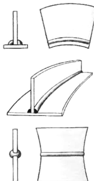
Литейная усадка происходит при остывании металла. Металл становится более плотным, его объем уменьшается, и в сварном соединении возникают внутренние напряжения. Из-за продольных напряжений изделие коробится в продольном направлении, а поперечные приводят, как правило, к угловым деформациям – короблению в сторону большего объема расплавленного металла.
