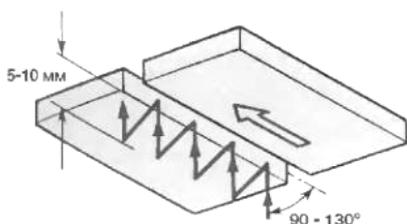
**Лесенкой.** Электрод располагают под углом к плоскости  $90-130^\circ$ , подводят к изделию и зажигают дугу. После образования маленькой порции расплавленного металла электрод отводят на 5-10мм от потолочной плоскости и возвращают, перекрывая закристаллизовавшуюся порцию металла расплавленным примерно на  $1/2 - 1/3$  ее длины.
