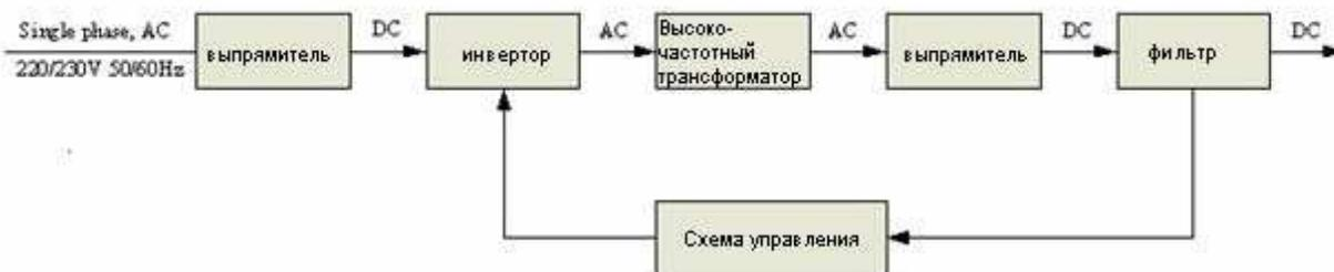
Управление количеством передаваемой энергии осуществляется в узле инвертора с помощью регулирования длительности полуволн напряжения – широтно-импульсной модуляции (ШИМ). Задание для узла инвертора формирует система управления источника. Система управления величину сварочного тока и напряжения, сравнивает их с требуемыми выходными характеристиками источника и меняет количество передаваемой энергии.
