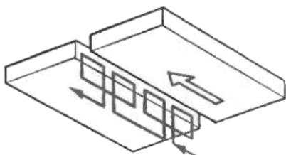
**Обратнопоступательно.** Концом электрода сварщик непрерывно возвращается назад, на кристаллизирующуюся часть металла, постоянно удлиняя валик
