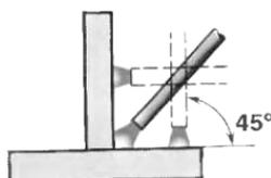
Угловые швы без скоса кромок с катетами более 10 мм выполняют в один слой поперечными движениями электрода треугольником с задержкой в корне шва
