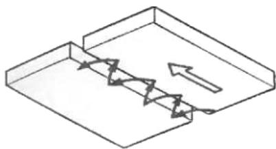
**Полумесяцем.** Электрод располагают под прямым углом 90-130° к потолочной плоскости и, манипулируя по схеме полумесяца, непрерывно заходят электродом на закристаллизовавшуюся часть металла.
