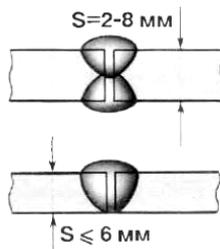
Металл толщиной более 8мм сваривают с разделкой кромок. Во избежание прожогов сварку ведут на съёмных медных или стальных пластинах.
